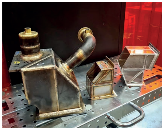
Drie van de proefstukken die Willems op het WK lassen moest maken (credits: WorldSkills Netherlands).
